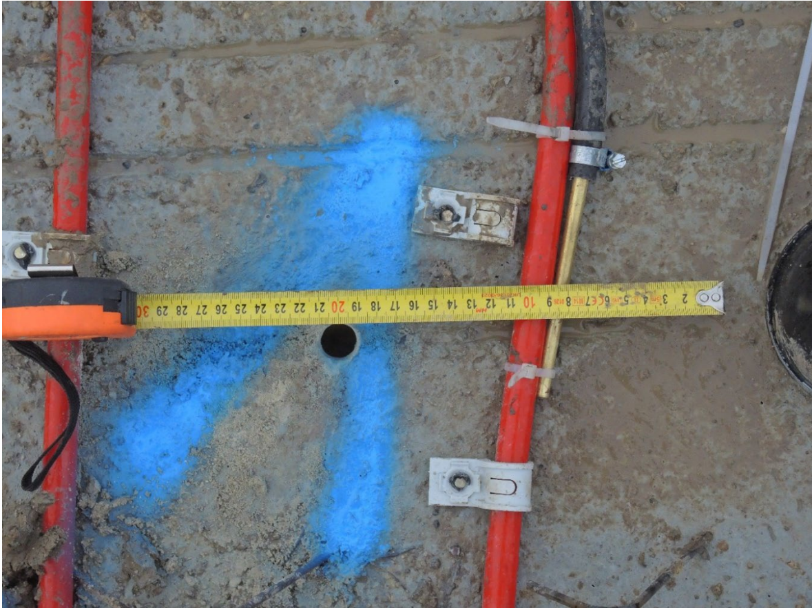
Abb. A 12: Reihenhaus RH_M, Messpunkt MP1: Befestigung der Hülse mit dem Temperatursensor am Registerrohr
